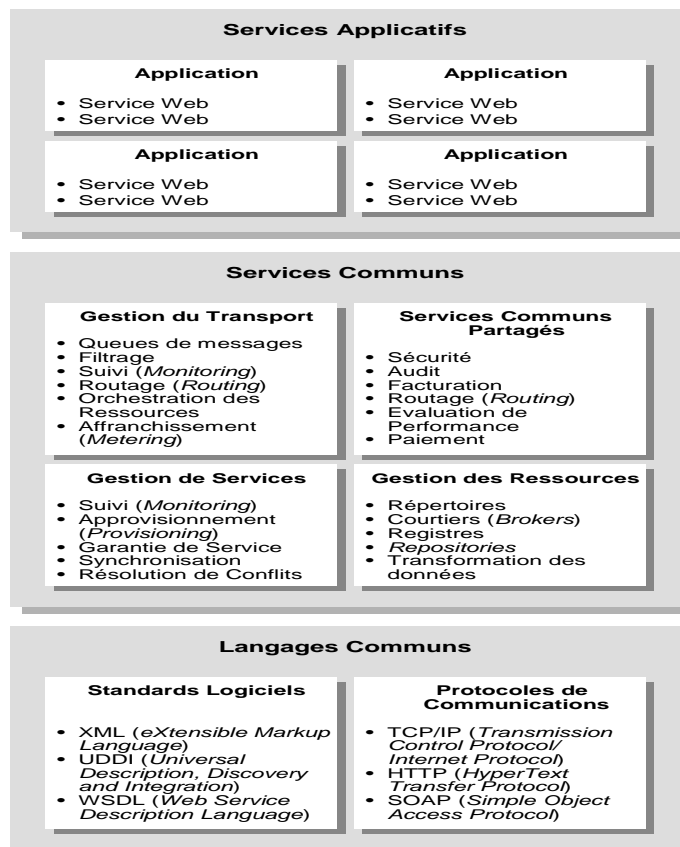
Figure 1 Les trois couches de l'architecture des services web
